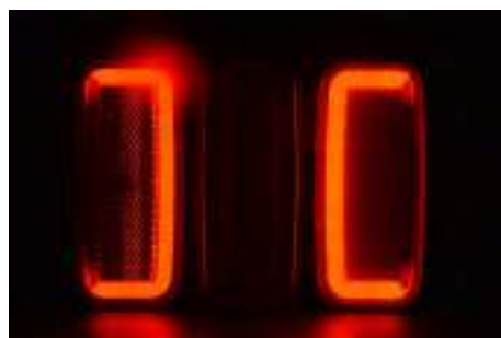
Tylne światło pozycyjne w dwóch modułach w kształcie dwóch odwróconych liter „C” / Tail light in two chambers 1 and 3 double „C” shape
