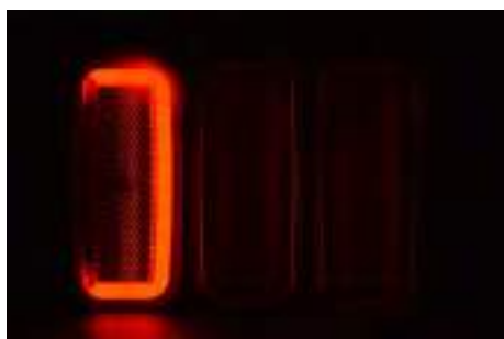
Tylne światło pozycyjne w kształcie litery „C” / Tail light in one chamber „C” shape
